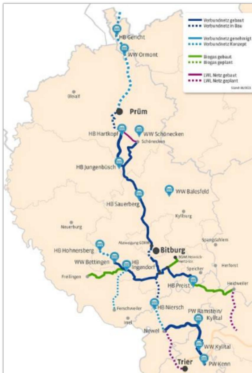
Der Fortschritt beim Bau der Eifel-Pipeline: Stand Juni 2021. HB steht für Hochbehälter, WW für Wasserwerk, PW für Pumpwerk. LWL: Lichtwellenleiter (Glasfaser). Und BGAA heißt Biogas-Aufbereitungsanlage. Foto: Landwerke Eifel
